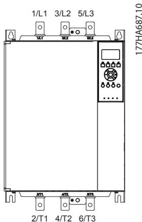
Ilustración 4.4 De MCD5-0131B a MCD5-0215B, 131-215 A
