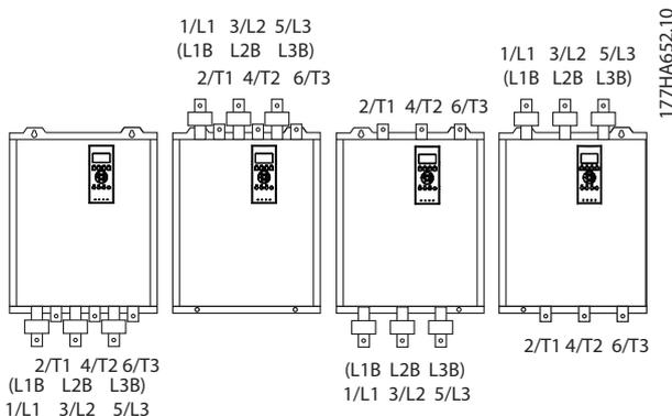
Ilustración 4.8 Ubicación de los terminales de bypass, de MCD5-0360C a MCD5-1600C, 360-1600 A
