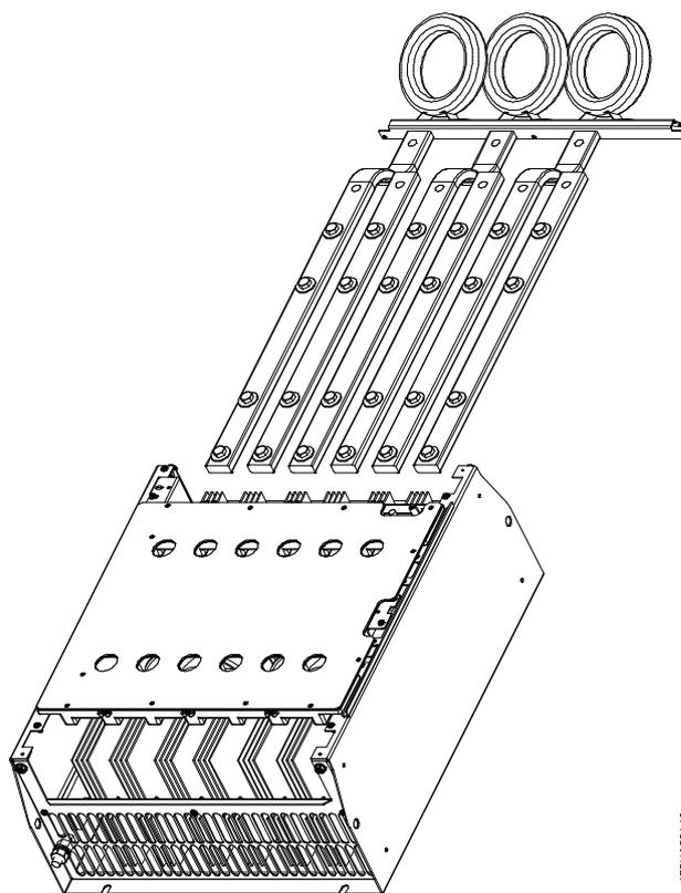
Ilustración 12.3 Barras conductoras con bridas para cables
