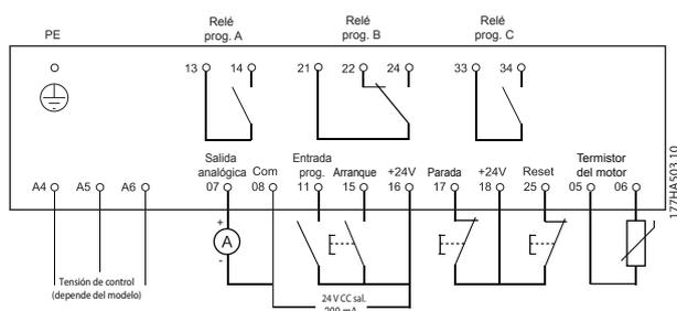
Ilustración 4.1 Cableado a los terminales de control
