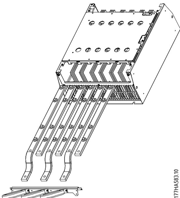
Ilustración 12.2 Barras conductoras
