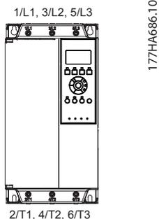
Ilustración 4.3 De MCD5-0021B a MCD5-0105B, 21-105 A
