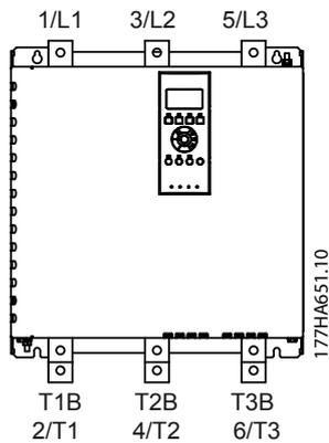
Ilustración 4.7 Terminales de bypass del MCD5-0245C, 245 A
