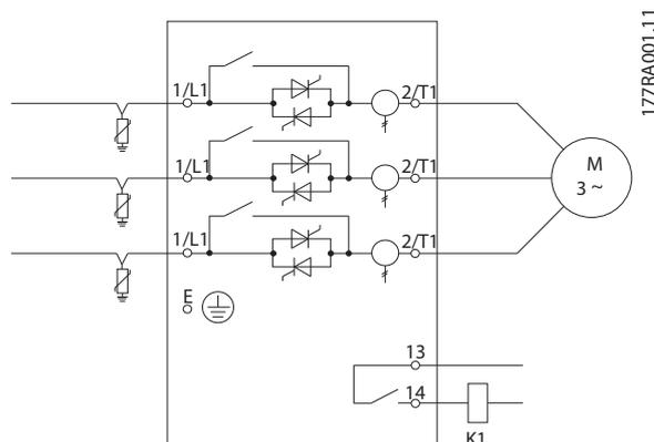
Ilustración 11.1 Sistema con kit de protección contra sobretensiones
