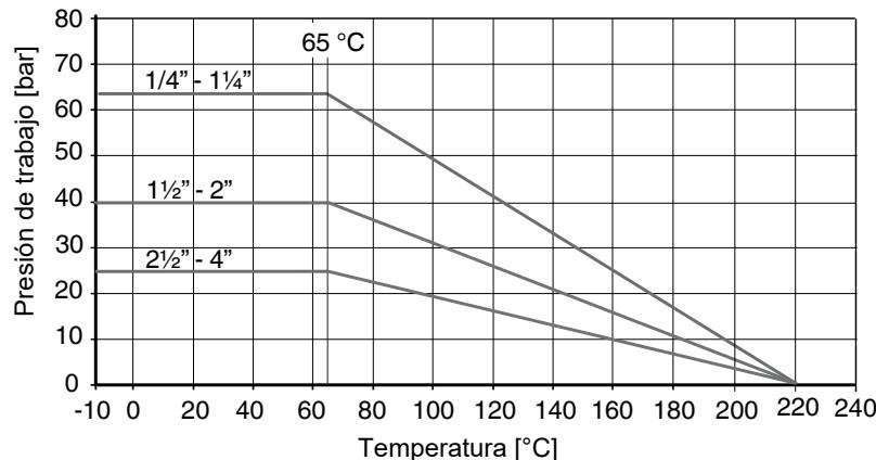
Utilizar la unión superpuesta con racor de presión con el nivel de presión adecuado para un montaje de tuberías seguro y correcto. Los niveles de presión de la unión por sí sola suelen ser más altos, pero no tienen en cuenta el conjunto completo encajado y con junta.
