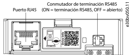
Ilustración 4: Puerto RJ45 y conmutador de terminación RS485
